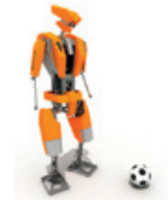
Figuur 1: De drie TU's (Delft, Twente en Eindhoven) werken samen met Philips aan de ontwikkeling van humanoid robots. Als benchmark om de functionaliteit te toetsen wordt mee gedaan aan de Robocup, voetbalwedstrijden tussen robots. Hiervoor moeten er goede mechanische functies (lopen, keren, rennen, schieten, stabiliteit) en sensorische (camerasystemen met real-time beeldverwerking) ontwikkeld worden.
