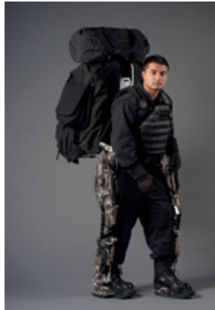
Figuur 2: Bleex is een exoskelet ontwikkeld door de University of Berkeley, vooral met een militaire toepassing. Door het exoskelet kan er een gewicht tot 60 kg gedragen worden over langere afstanden. Grootste probleem is de energievoorziening, een deel van de rugzak wordt ingenomen door een benzinemotor voor de aandrijving!
